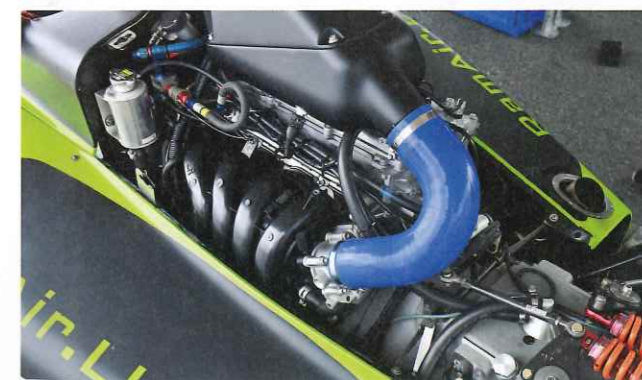
▲レッスンで使用するF4マシンは2.0直4エンジン(160ps)搭載。トランスミッションは6速パドルシフト。シャシーはカーボンモノコック製のDOME・F110。全長4340mm、全高950mm
