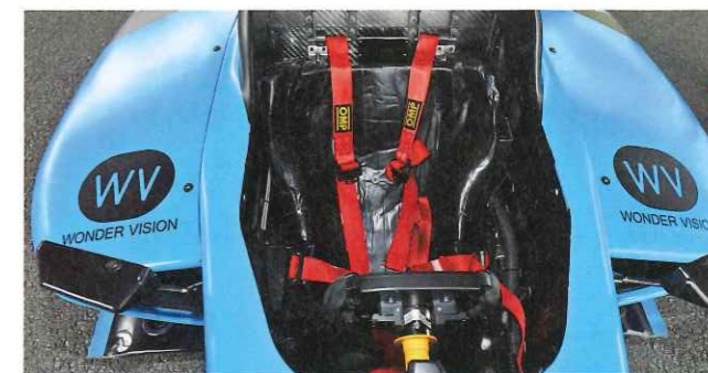
▲6点式シートベルトでドライバーをがっちり固定する。シートに前座ると一気に気分が高まっていく。前方に見えるタイヤの存在がフォーミュラマシンに乗っている現実を印象づける
